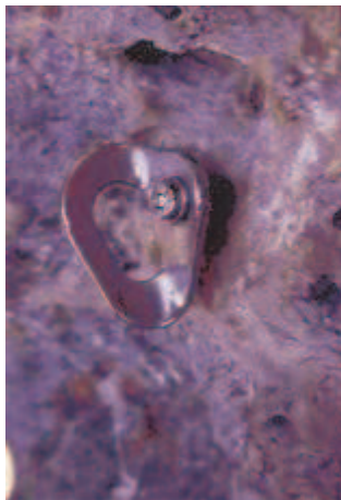
Bild 3: gelockerter Long Life-Haken: Der Dübel ist bereits einige cm aus dem Fels "gewandert", die Hakenlasche liegt nicht mehr am Fels auf.
