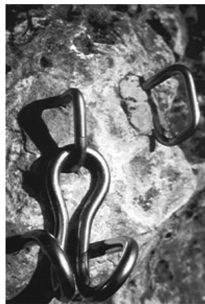
Das Objekt der Begierde: eine Umlenkschnecke, daneben ein vom unsachgemäßen Topropen abgeschliffener Bühlerhaken (Röthelfels, Treusteiner Ged. Weg)
