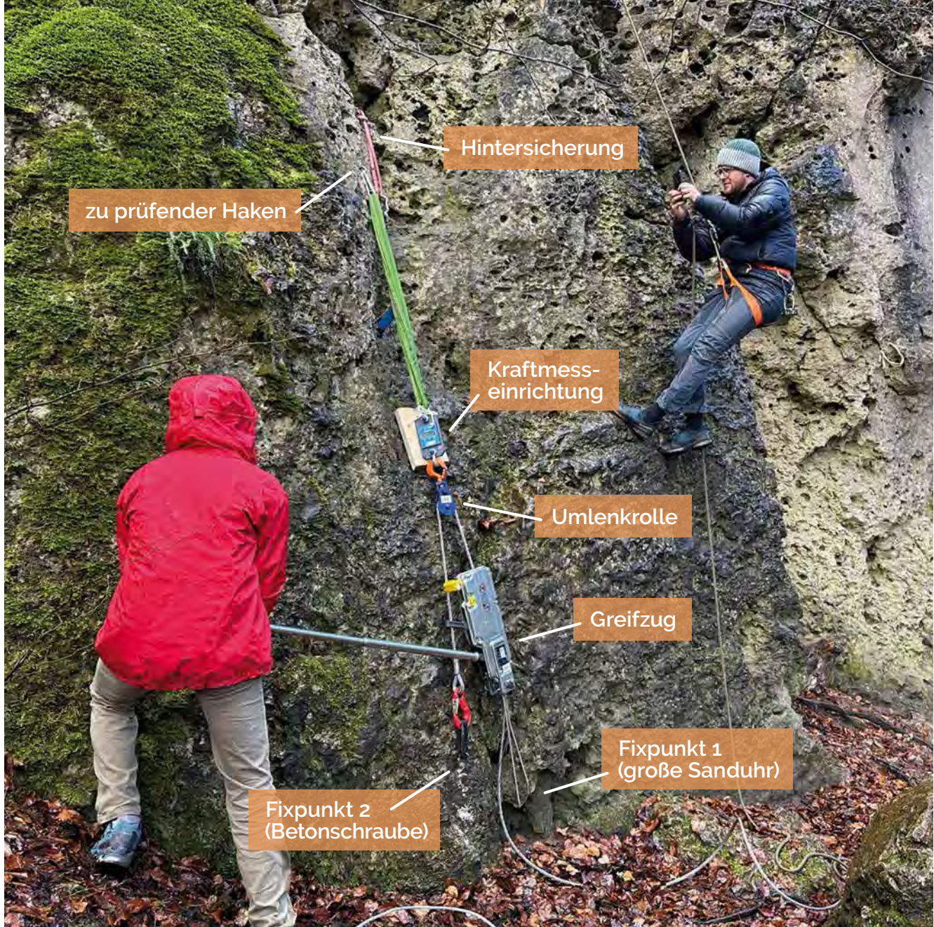
Grundsätzlicher Aufbau der Hakenauszugseinrichtung
